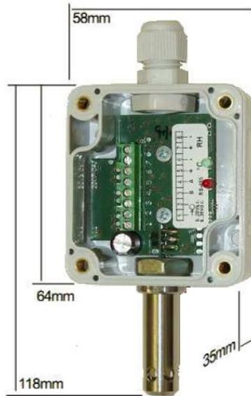
Fixation murale par 2 trous de vis à l'extérieur du boîtier principal qui est IP65
