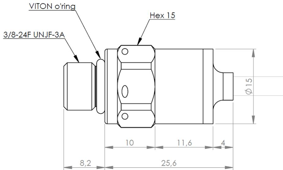
Couple de serrage : 4 Nm (max : 10 Nm)
