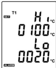
Ce menu permet de paramétrer les valeurs minimale et maximale de température souhaitées qui déclencheront une alarme si elles sont atteintes. Un son sera alors émis et une indication « alarm Hi » ou « alarm Lo » s'affichera à l'écran.
