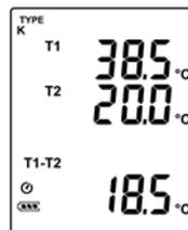
Les flèches directionnelles haut et bas permettent d'activer ou non le mode de soustraction T1-T2.
