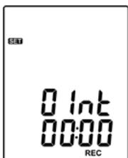
Les touches directionnelles gauche et droite permettent de sélectionner le paramètre à ajuster (minutes ou secondes) et les touches haut et bas à augmenter ou diminuer la valeur de ce paramètre.
