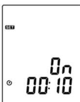
Dans ce menu, les flèches directionnelles haut et bas permettent d'activer l'option de mise hors tension automatique et de définir le temps souhaité (10, 30 minutes, 1, 2, 4 ou 8 heures).
