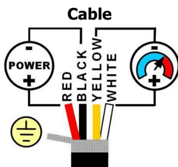
Câble blindé PVC 105 ° C, Ø5,2 mm avec 4 conducteurs étamés Ø0,35 mm<sup>2</sup>.
